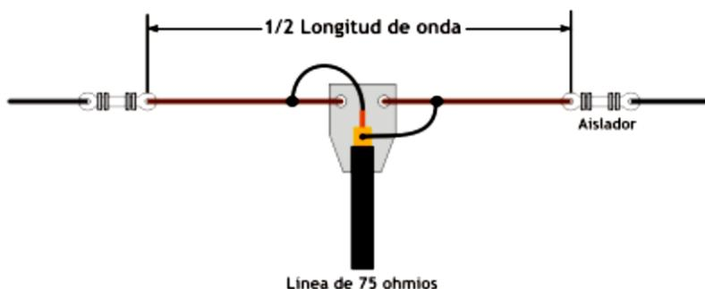
Para una frecuencia de 28950 KHz la longitud de un dipolo de media onda será:
