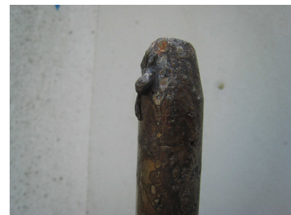
Fusión en microsegundos (pararrayos)
